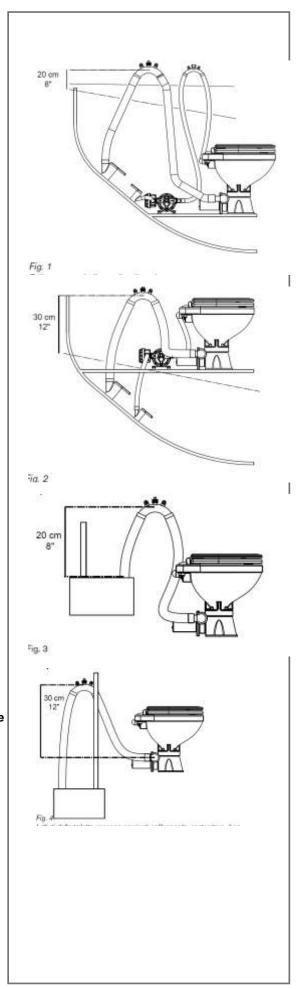
Alternativa 4 Scarico dei rifiuti della toilette in un apposito contenitore (il gomito di scarico è sempre sopra la parte superiore del contenitore 30 cm. 12") Fig. 4
